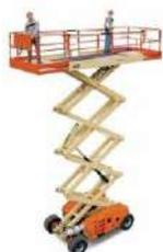
**CATEGORIE A TYPE 3 :** PEMP dont l'élévation est verticale, dont la translation peut être commandée par un organe situé sur la plateforme de travail lorsque celle-ci est en position haute.
