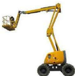
**CATEGORIE B TYPE 3 :** PEMP dont l'élévation est multidirectionnelle, dont la translation peut être commandée par un organe situé sur la plateforme de travail lorsque celle-ci est en position haute.
